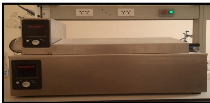
الشكل (IV-10): حمام مائي هزاز المستعمل في عملية الامتزاز.
