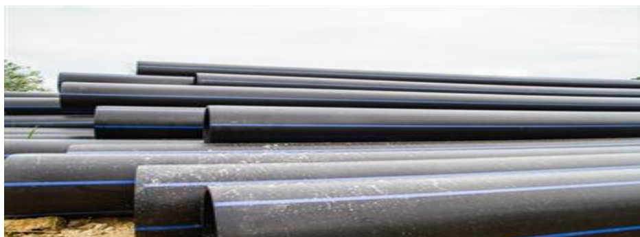
Figure II-11 : Conduites en (PEHD)
