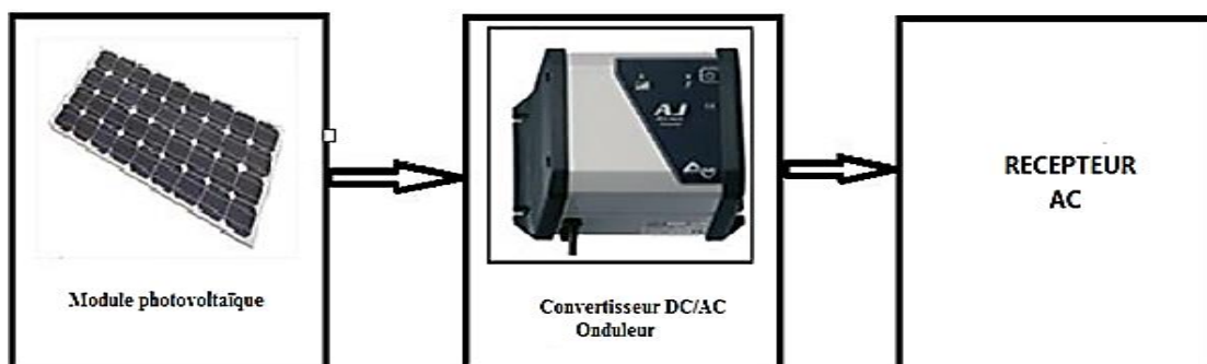
Figure I 6: schéma de convertisseur de système photovoltaïque[8].
