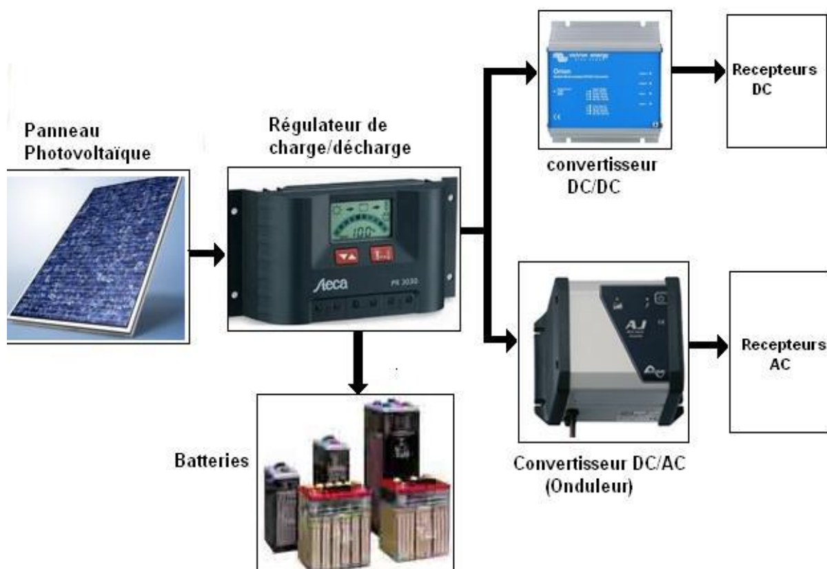
Figure I 3:Représentation synoptique de la structure d'un système photovoltaïque avec stockage [8]
