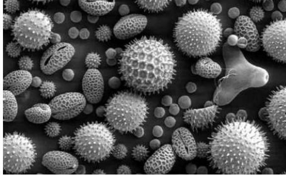
الشكل 25: صورة توضح حبيبات اللقاح أخذت بواسطة جهاز SEM وترى بوضوح عمق التبئير في الصورة لتبدو ثلاثية الابعاد[7]
