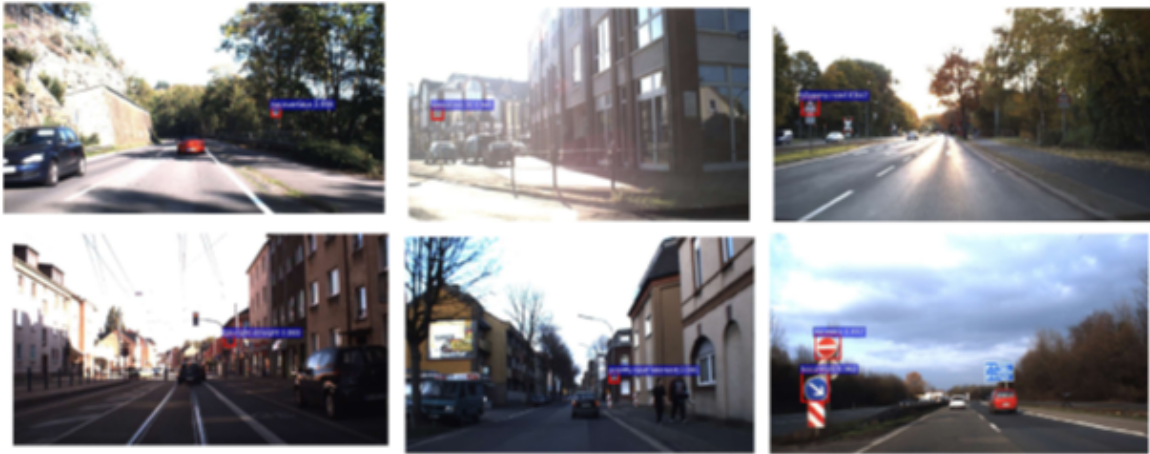
FIGURE 2.7 – Localisation et reconnaissance des panneaux de signalisation sur certaines images.
