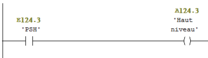
Figure 4-6 Détection haut niveau BAC1
