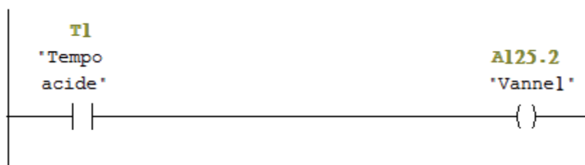
Figure 4-8 La temporisation T1 d'acide
