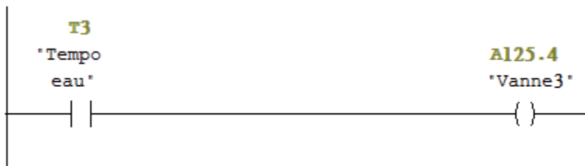
Figure 4-10 La temporisation T3 d'eau
