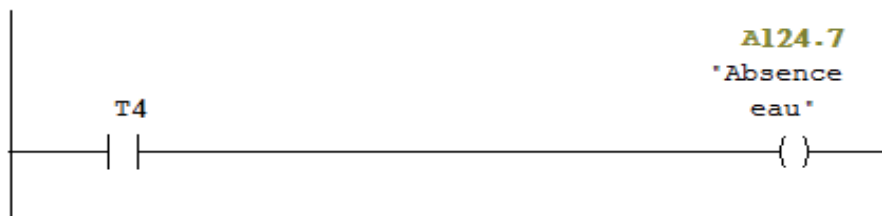
Figure 4-19 Défaut d'absence d'eau par T4
