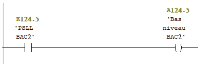
Figure 4-13 commandé l'expédition du produit ver BAC2
