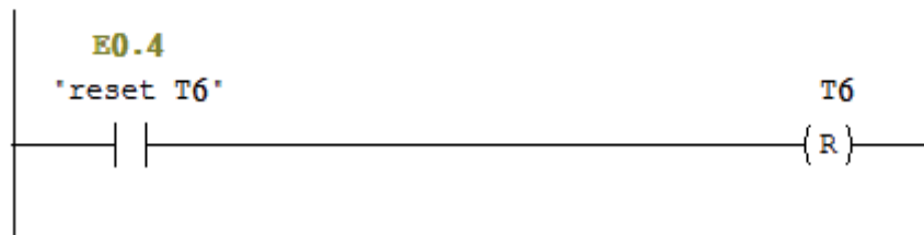
Figure 4-25 réinitialisation "reset T6
