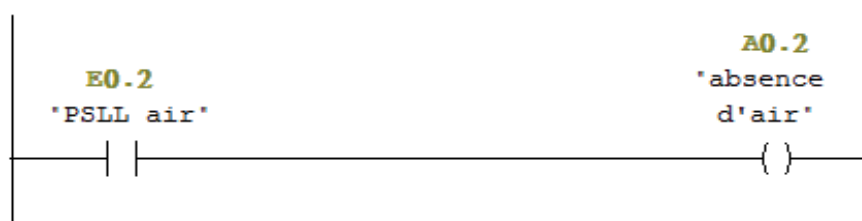
Figure 4-20 Défaut d'absence d'air instrument
