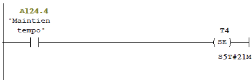
Figure 4-18 Défaut d'absence d'eau
