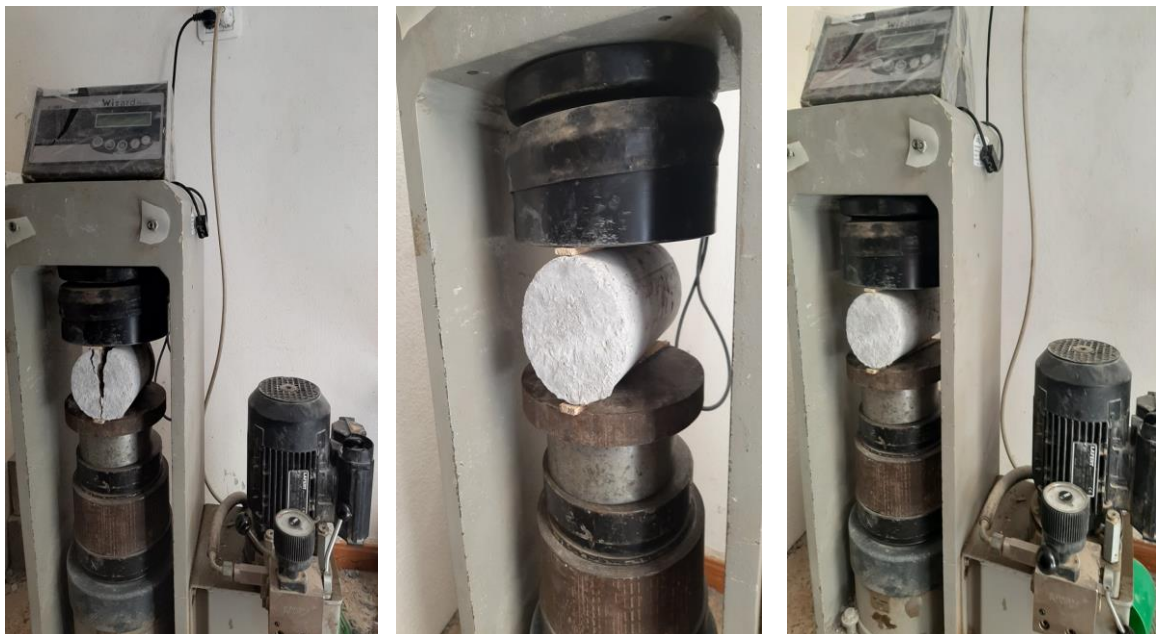
Figure III.7. essai de traction par fendage
