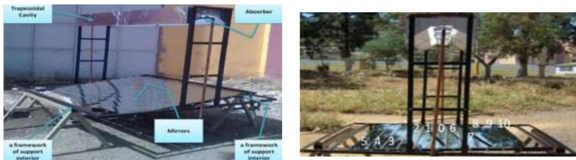
Figure I. 11 : Schéma représentant le dispositif expérimental de M. Ghodbane et al., (2016) [2, 12, 54].
