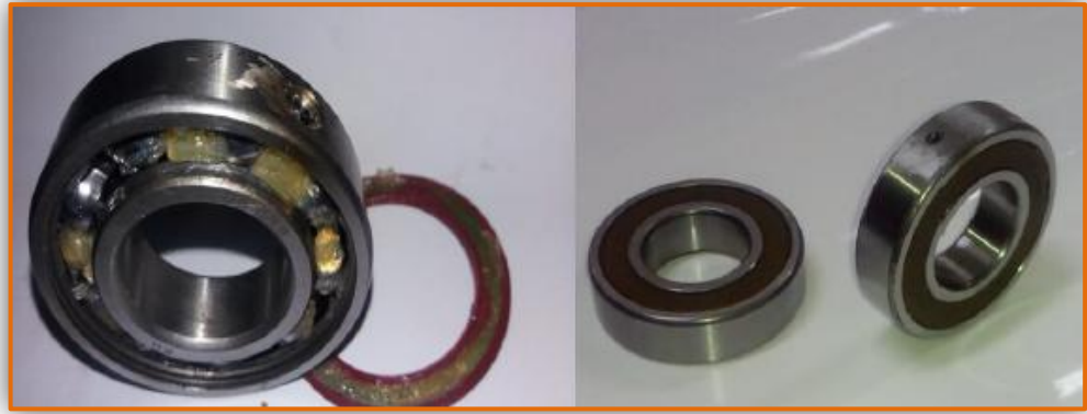
Figure III.1. Photos d'un roulement défectueux dans la BE.
