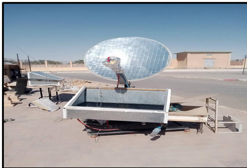
Figure III.16 : système distillation solaire avec un concentrateur solaire parabolique
