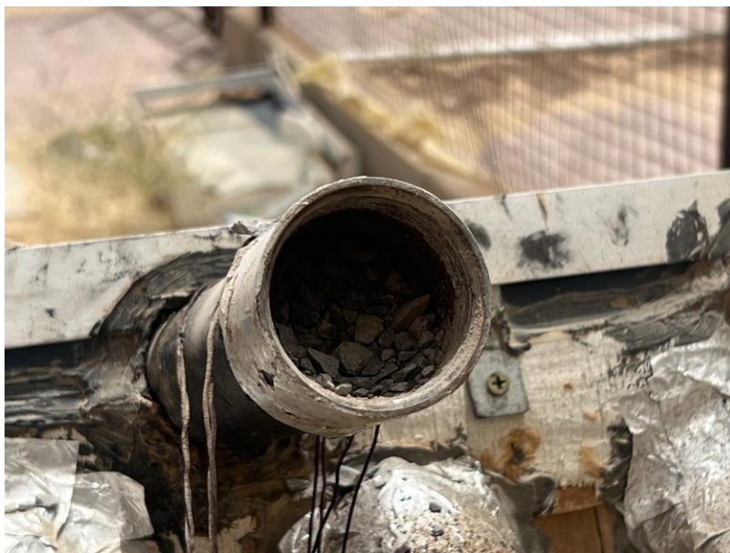
Figure 23. Ajout de matériau de stockage thermique à l'intérieur du capteur solaire
