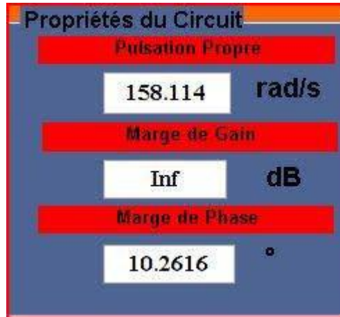
Figure IV.26. Propriétés du circuit.
