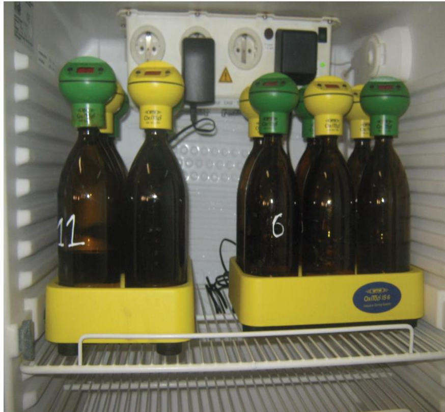
Photo 18: DBO mètre pour la détermination de DBO5.
