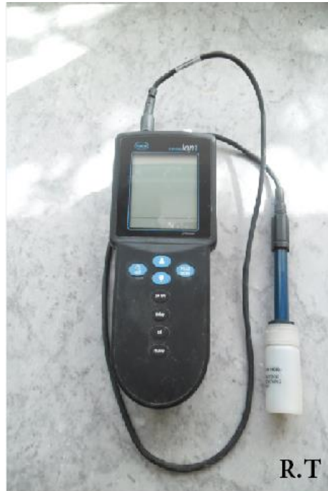
Photo 12: pH mètre pour mesurer le pH.
