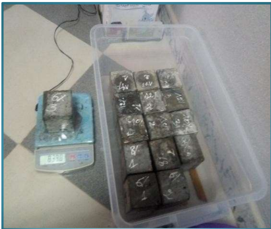
Figure II.13: L'essai d'absorption par capillarité
