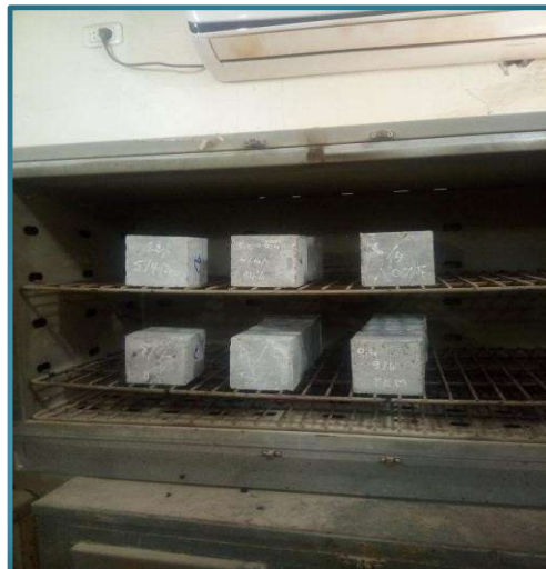
Figure II-12 séchage des éprouvettes dans le four.
