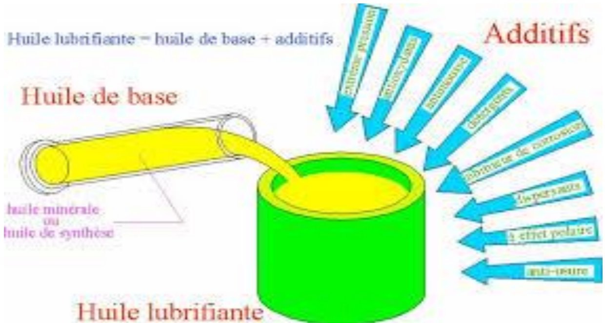
Figure 2 Principe de composition d'un huile lubrifiante
