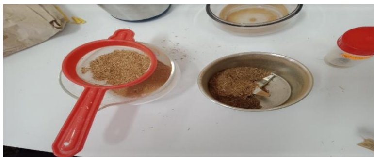
الصورة 04: توضح عملية الغربلة لعينة مخلفات النخيل (العرجون)
