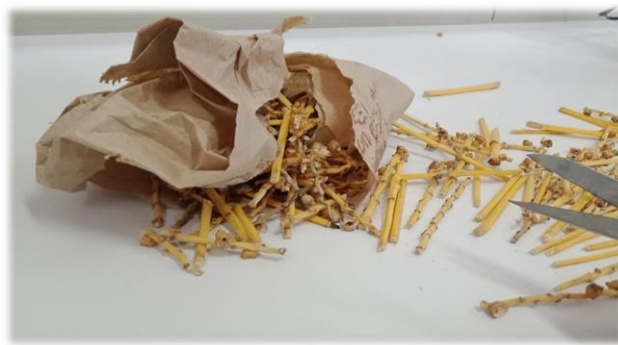
الصورة 03: توضيح كيفية تحضير عينة من مخلفات النخيل (الرجون)
