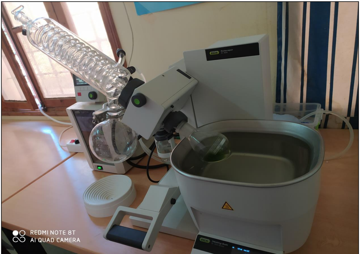
الصورة (07): جهاز التبخير الدوراني (Rotavapeur) المستعمل في الدراسة. (صورة فوتوغرافية حقيقية - لفيقه، بن علي، 2020)
