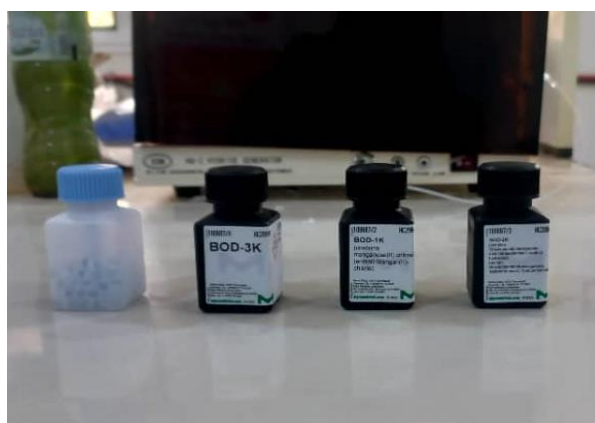
الشكل III-11: صورة للكواشف المستعملة في DBO_5 مع قارورة الخرز الزجاجية.
