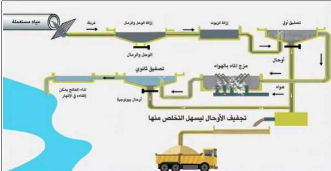
الشكل I- 8: مراحل معالجة المياه المستعملة [16].
