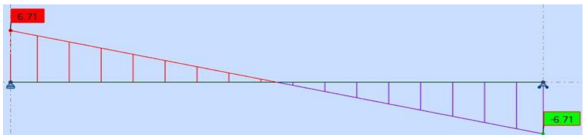
Figure 3.17 : Diagramme des efforts tranchants type4 de l'étage courant ((ELU))
