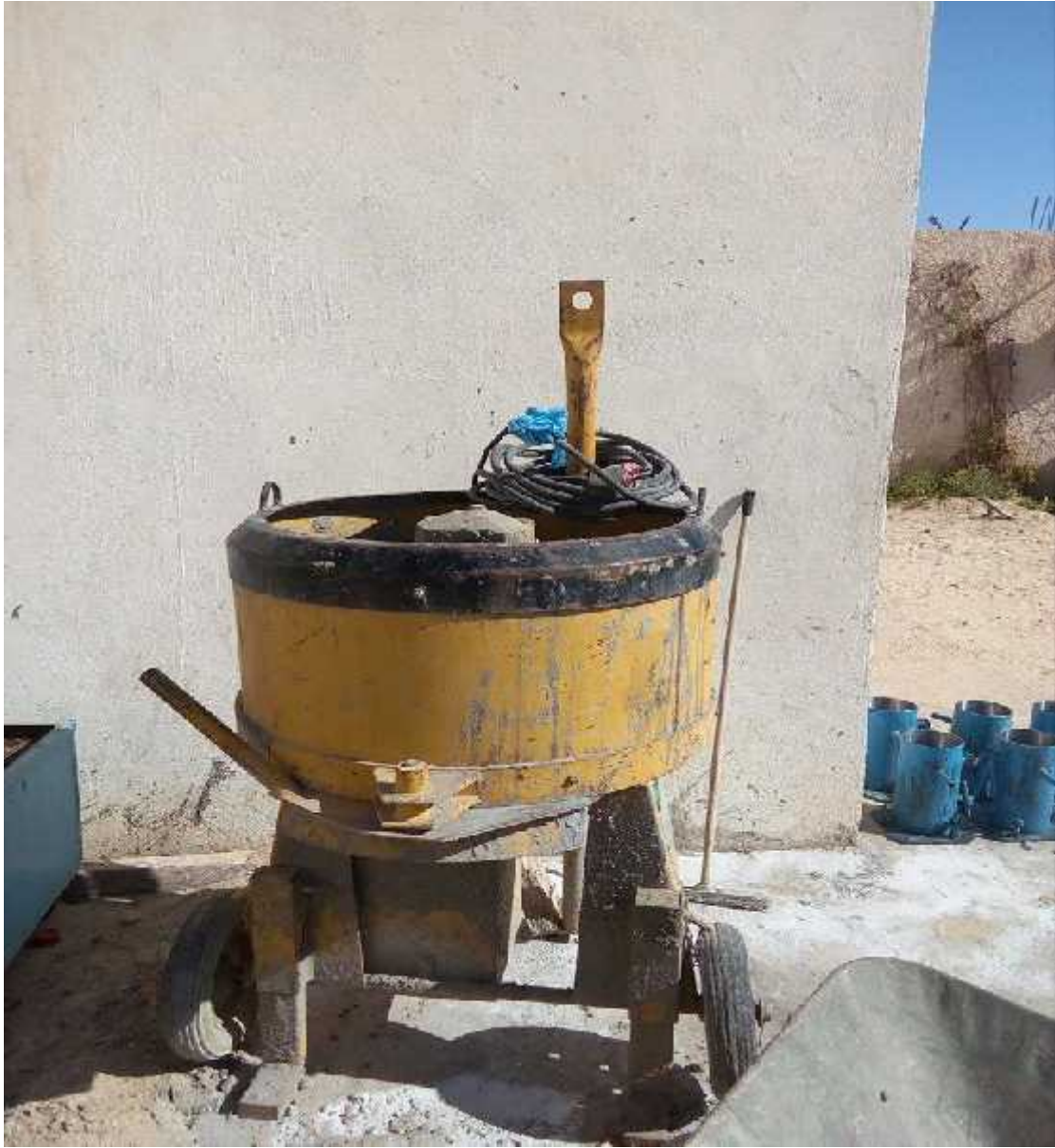
الصورة III . 3 آلة خلط الخرسانة (EN 1297-3)
