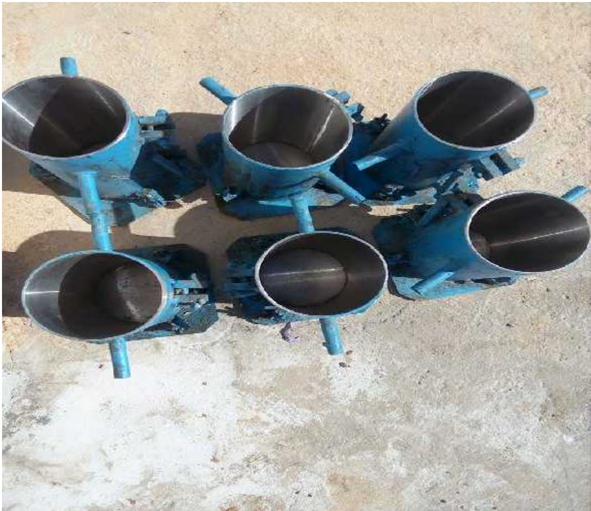
الصورة III 5: قوالب الصب
