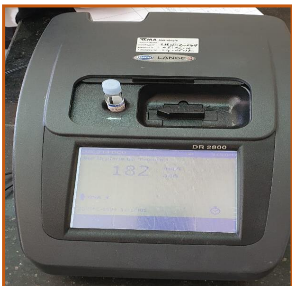
Photo III.11: Réactifs et appareils de mesure de la DCO
