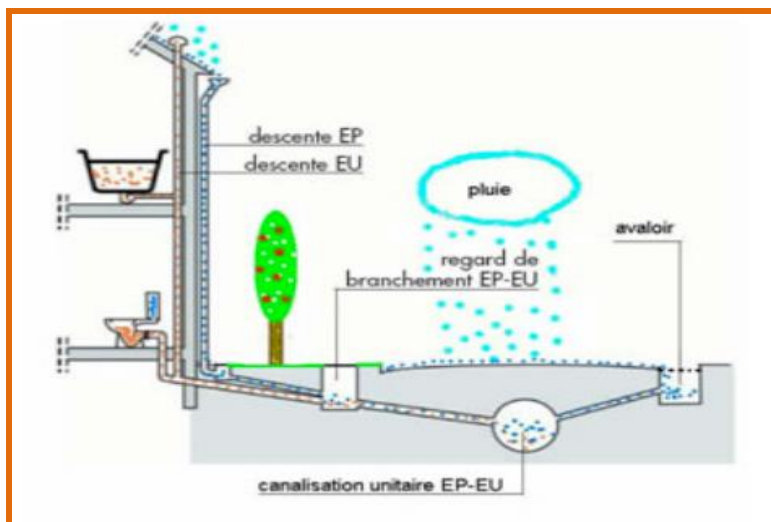
Figure I.01: Schéma explicatif du réseau unitaire
