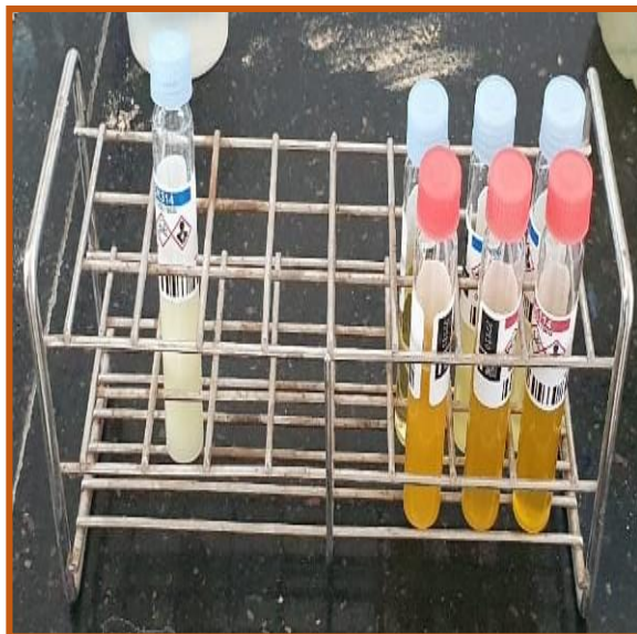
Photo III.11: Réactifs et appareils de mesure de la DCO
