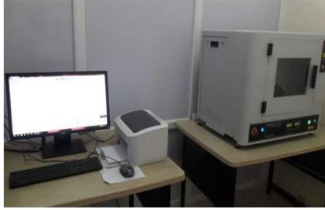
الشكل (II-17): جهاز PROTO المستعمل في تقنية حيود الأشعة السينية.
