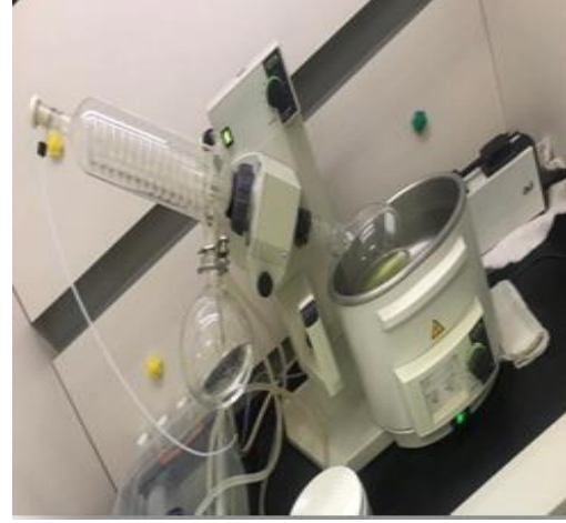
الوثيقة (22): صورة لجهاز المبخر الدوراني (Rotavapeur)
