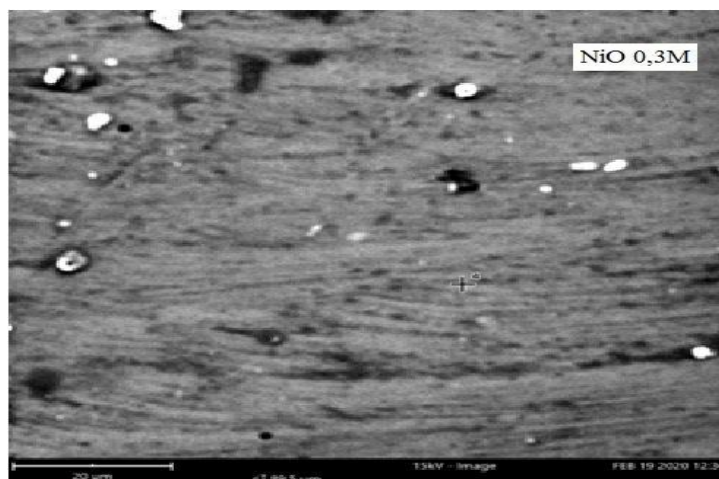
الشكل (7-3): صورة بالمجهر الإلكتروني الماسح عند التركيز 0.3 M لطبقة NiO/FTO.
