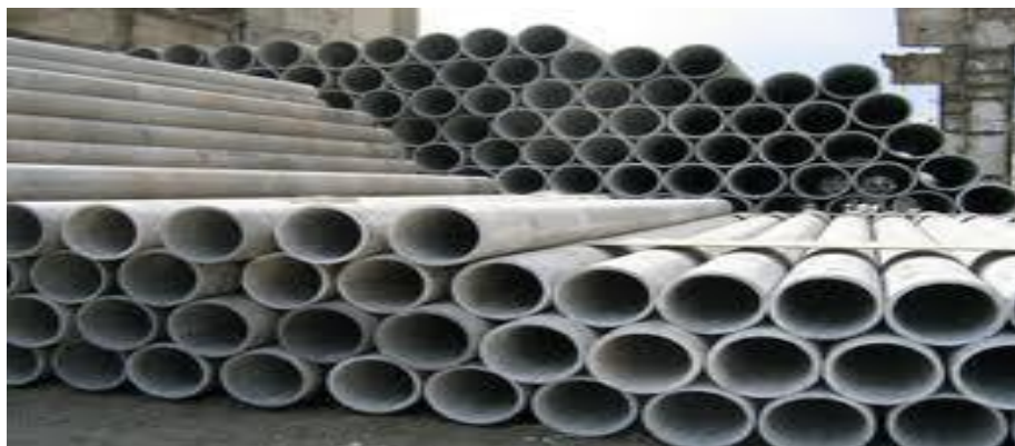
PHOTO III.4 : Conduite en amiante ciment.
