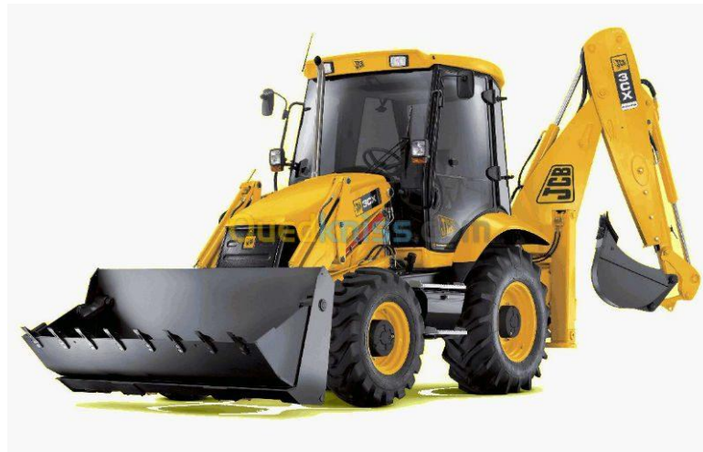
PHOTO VII.4. 'retro' pour l'exécution des tranchées
