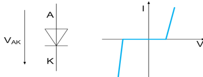
Figure III .10. Représentation symbolique de la diode et la caractéristique d'une diode
