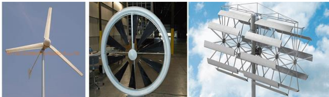
Figure I.4. Aérogénérateur à axe horizontal [3]
