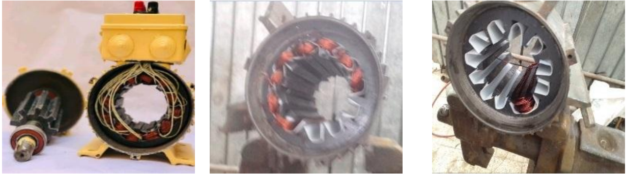
Figure II.25: Étape du processus de bobinage de la GRV.
