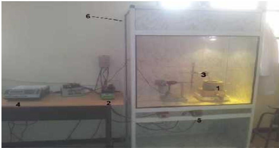
الشكل (III.1): التركيب التجريبي لتقنية الأمواج فوق الصوتية.
