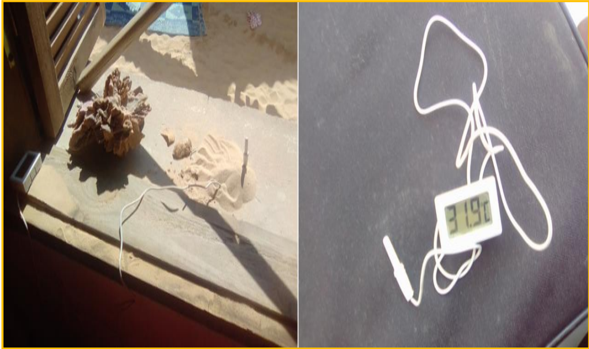
الشكل (6.3) : صورة جهاز الترموكوبل لقياس درجة حرارة الجو .
