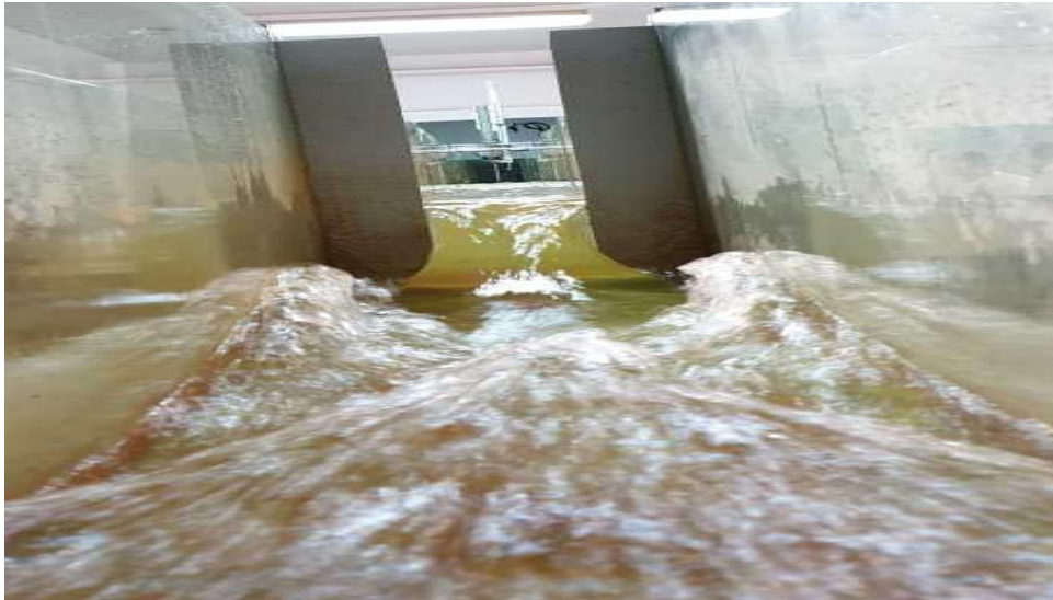
Figure 3-3 Déversoir rectangulaire utilisé aux mesures des lames déversant
