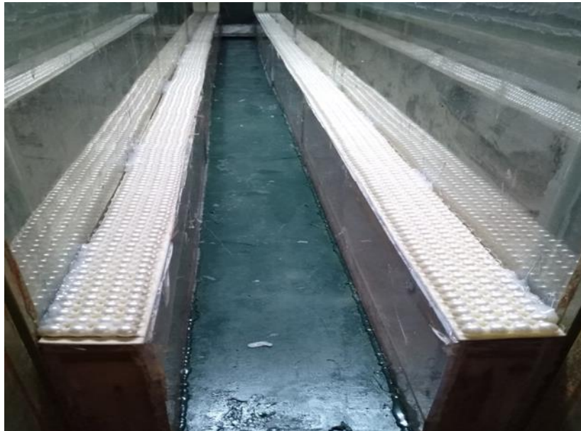
Figure 3-4 Photographie d'un tapis rugueux soigneusement collé sur le lit majeur du canal rectangulaire de section composée
