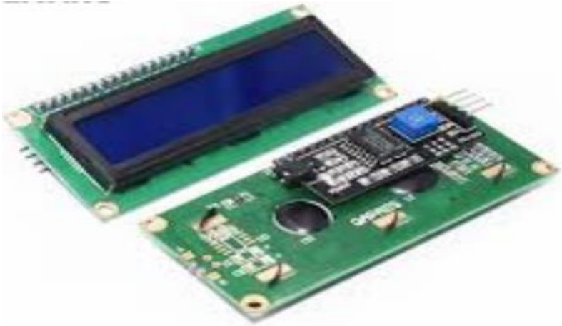
Figure (II-18) : Ecran LCD avec système de connexion I2C
