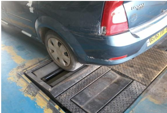
Figure1.15- la voiture Logan sur le banc de contrôle
