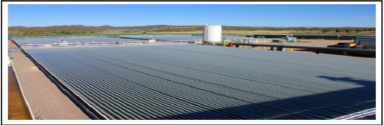
Figure 26: PBR tubulaires horizontaux immergés dans de l’eau, Solix’s Lumian™ Algae Growth System .( Wolff A.,2010).
