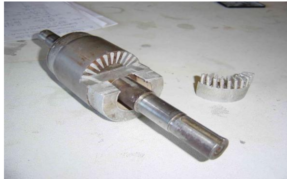
Figure I.3. Rotor à cage d'écureuil
