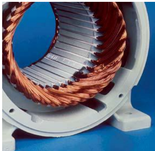
Figure I.2. Stator après bobinage
