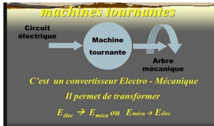
Figure (II.15) : Fonction d'une machine tournante.
