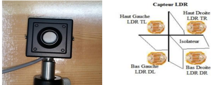
Figure (II.11) : Capteurs en quatre quadrants en forme (+).
