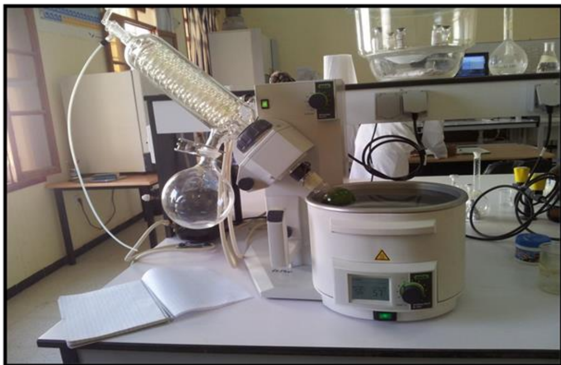
شكل 19: صورة توضح جهاز المبخر الدوراني Rotavapeur
