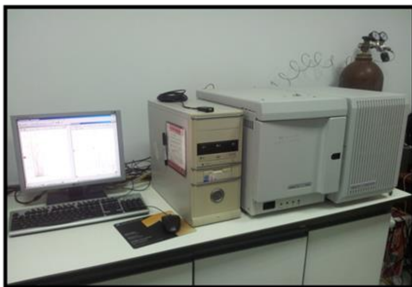
شكل 17: صورة توضح جهاز GC/MS.
