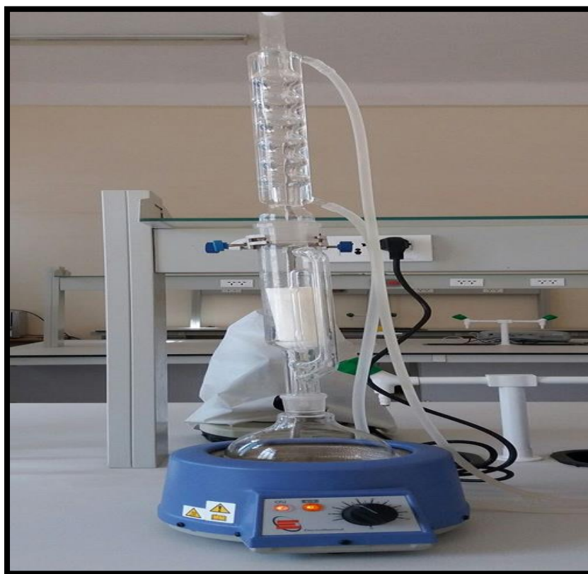
شكل 18: صورة توضح جهاز سوكسلي Soxhle
