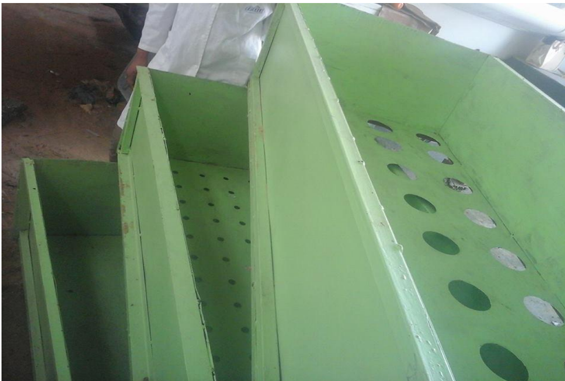
Figure 9 : Table de tri granulométrique utilisé pour séparer les déchets selon leur taille (photo personnelle, 11-04-2017).
