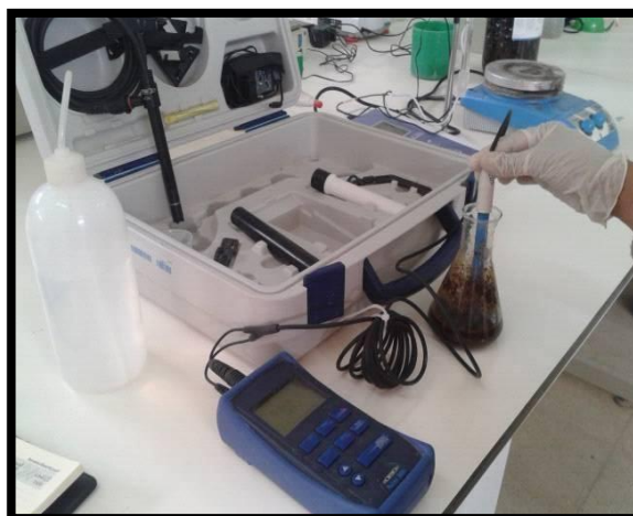
Préparation de solution de pH (Agitation magnétique)
