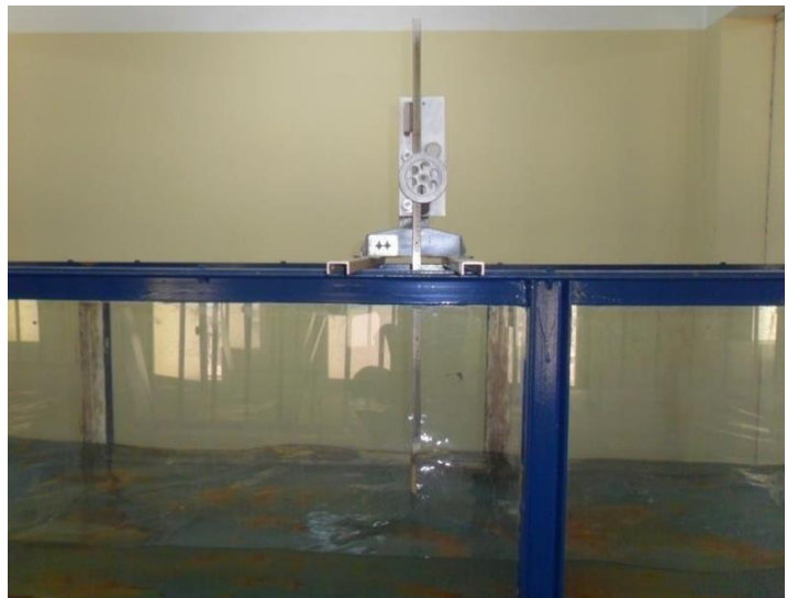
Photo.4.7 Photographie du déversoir rectangulaire sans hauteur de pelle avec contraction latérale ayant servi à la mesure du débit
