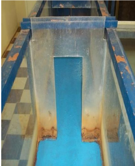
Photo.4.7 Photographie du déversoir rectangulaire sans hauteur de pelle avec contraction latérale ayant servi à la mesure du débit
