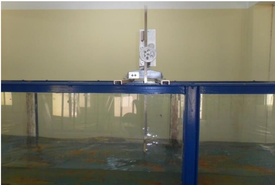
Photo.4.3 Photographie du déversoir rectangulaire sans hauteur de pelle avec contraction latérale ayant servi à la mesure du débit
