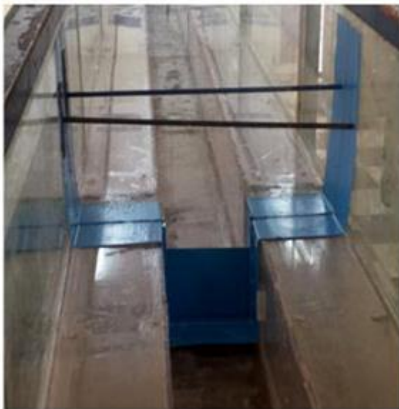
Photo.4.6 : Photographie de support du seuil.
