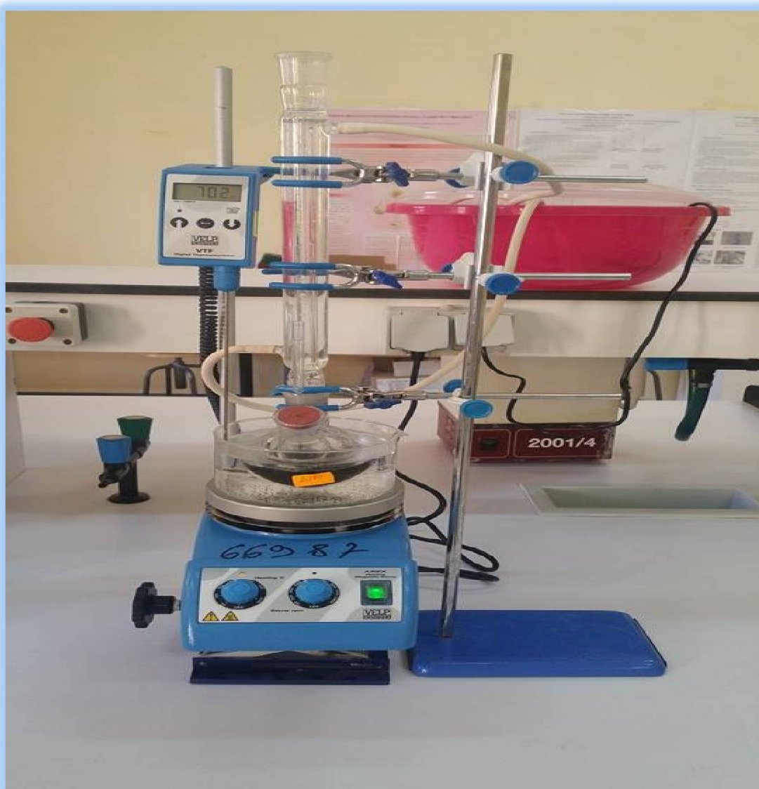
Fig.IV.4: Schéma du montage de chauffage à reflux de réaction d'estérification
