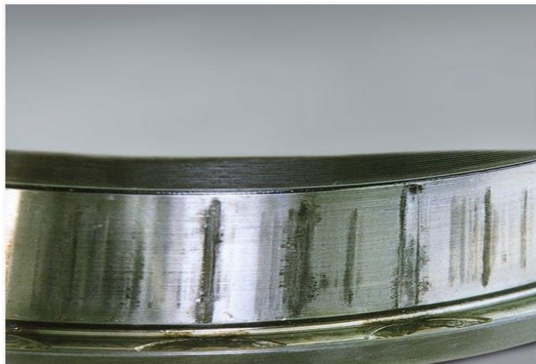
Figure II.4 Usure sur la bague Intérieure.
