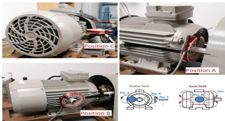
Figure II.22 Positions du capteur de bobine [Vic 21].
