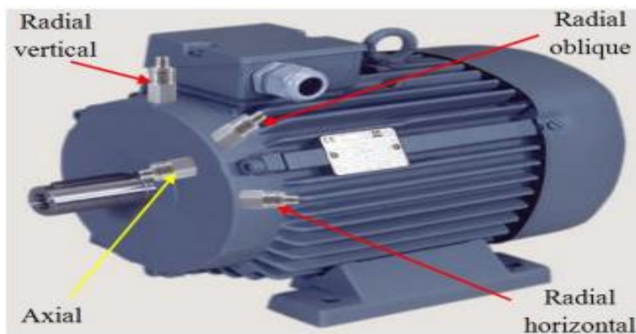
Figure II.18 Différents points de mesure des vibrations d'une MAS [Bes 17].
