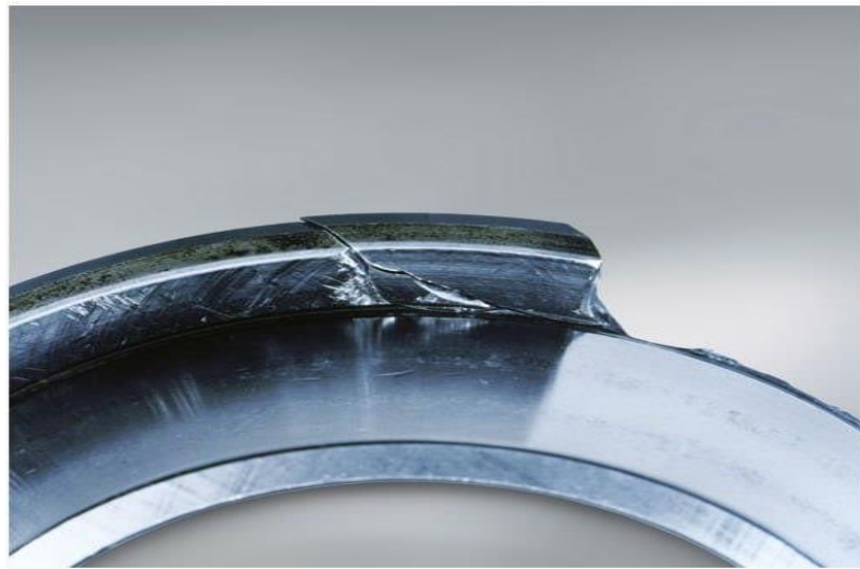
Figure II.2 Fracture sur la bague extérieure.
