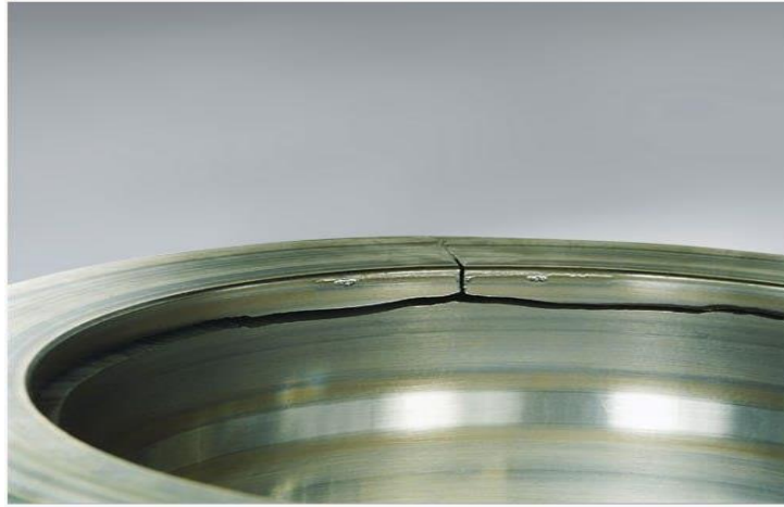
Figure II.3 Fissures sur la bague extérieure.
