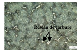
Figure.6 : Micrographie optique de l'acier étudié
