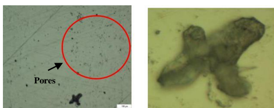
Figure.4 : Micrographie de la surface polie de l'échantillon de départ, sans attaque chimique.
