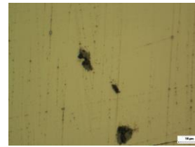
Figure.5 : Détails de défauts sur la surface polie et non attaquée de l'échantillon : inclusion d'oxydes, Présence de pores et d'inclusion non métallique en forme de trèfle, probablement un oxysulfure.
