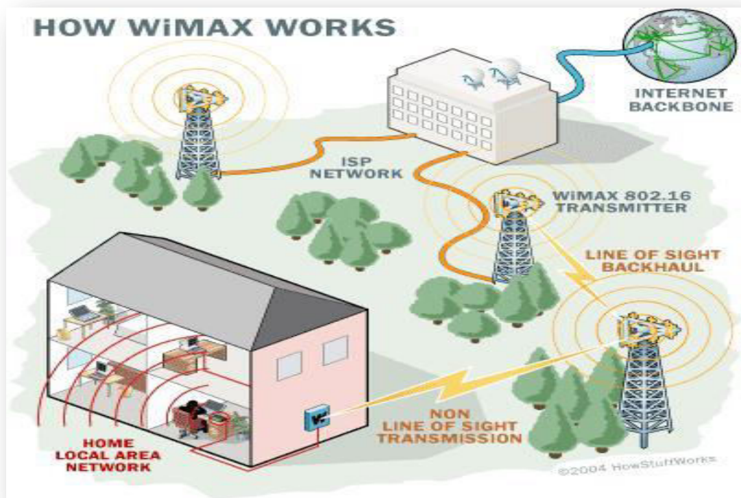
Figure I.2 : Le principe de fonctionnement du WiMAX
