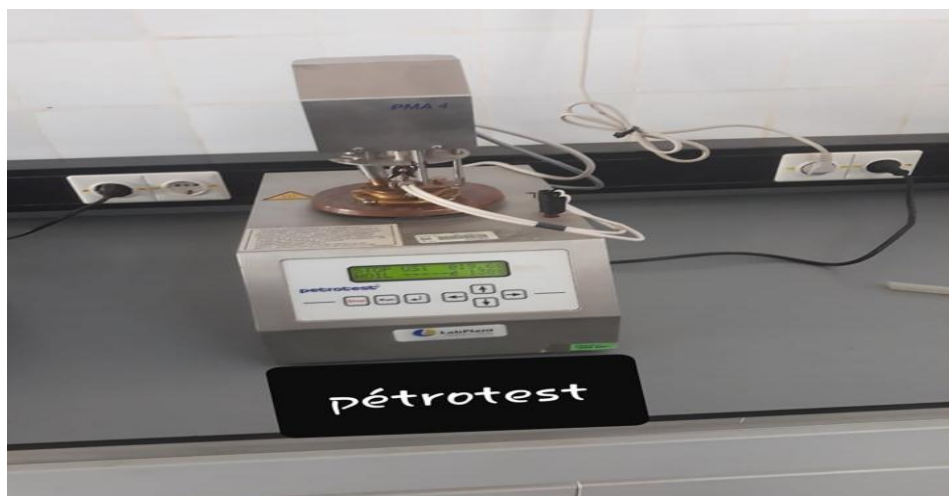
Figure (II.15) Appareil de mesure la point de claire d'huile
