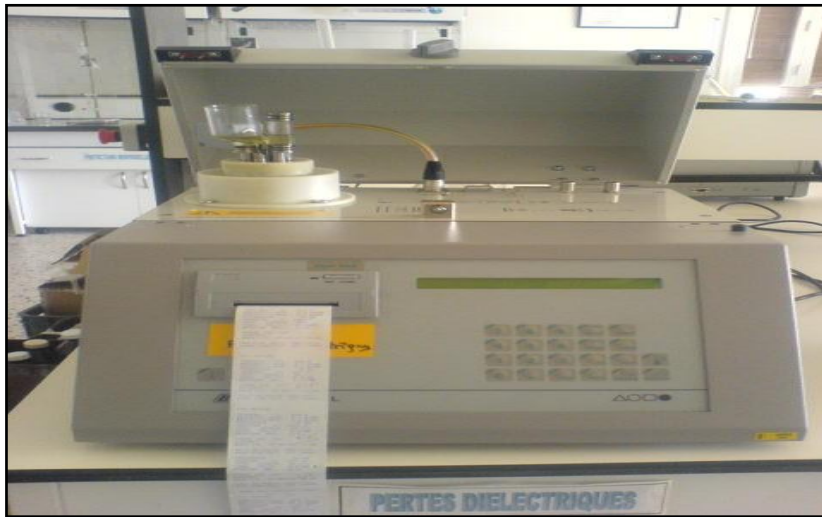
Figure (II.10) Appareil de mesure de \tan \delta , \epsilon_r et \rho
