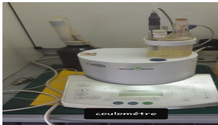
Figure (II.12) coulométrie de mesure de la teneur en eau
