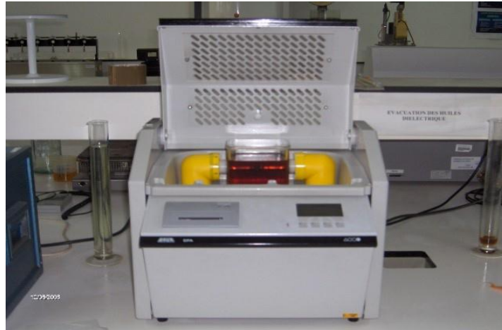
Figure (II.13) Appareil de mesure de la tension de claquage.
