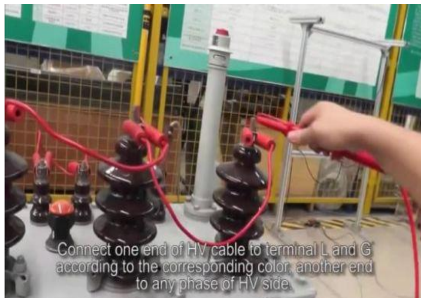
Figure (II.11) Mesure de résistance d'isolement de transformateur puissance[2]
