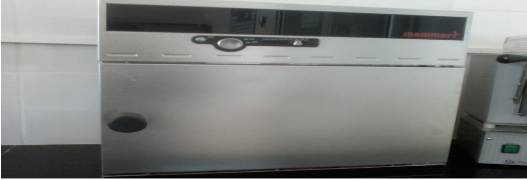
الشكل (9.III): يمثل فرن كهربائي ( Etuve )
