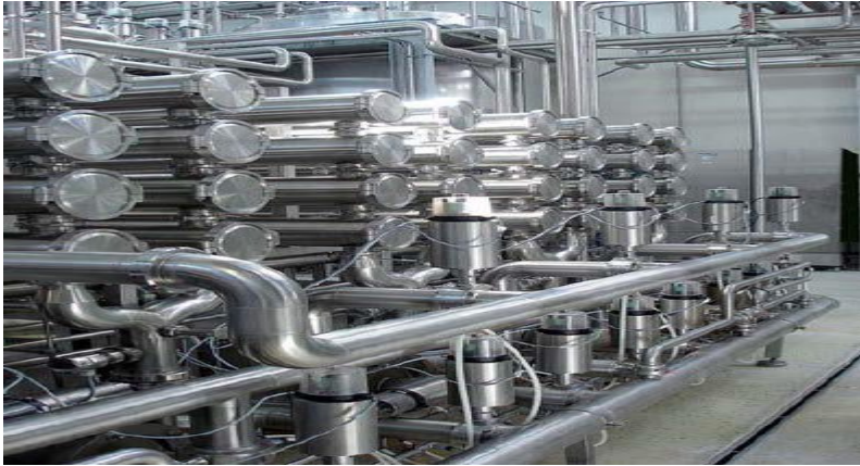
الشكل (I- 9): مصنع الترشيح الدقيق الغشائي لترشيح الجيلاتين منخفض الوزن الجزيئي
