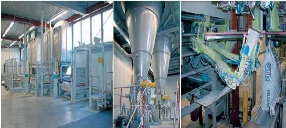
الشكل (I- 13): محطات المزج والتعبئة شبه الأوتوماتيكية للجيلاتين الحبيبي. [25]
