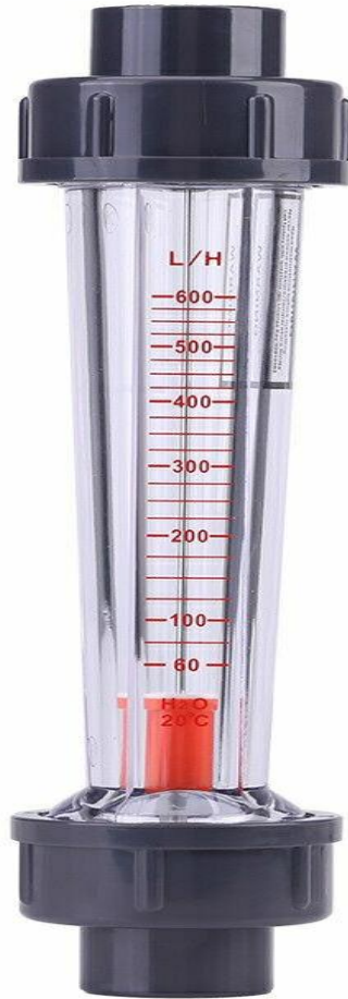
Figure I- 11: débitmètre à section variable: RotaMètre. [7]
