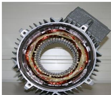
Figure I.1. Schéma d'un stator.
