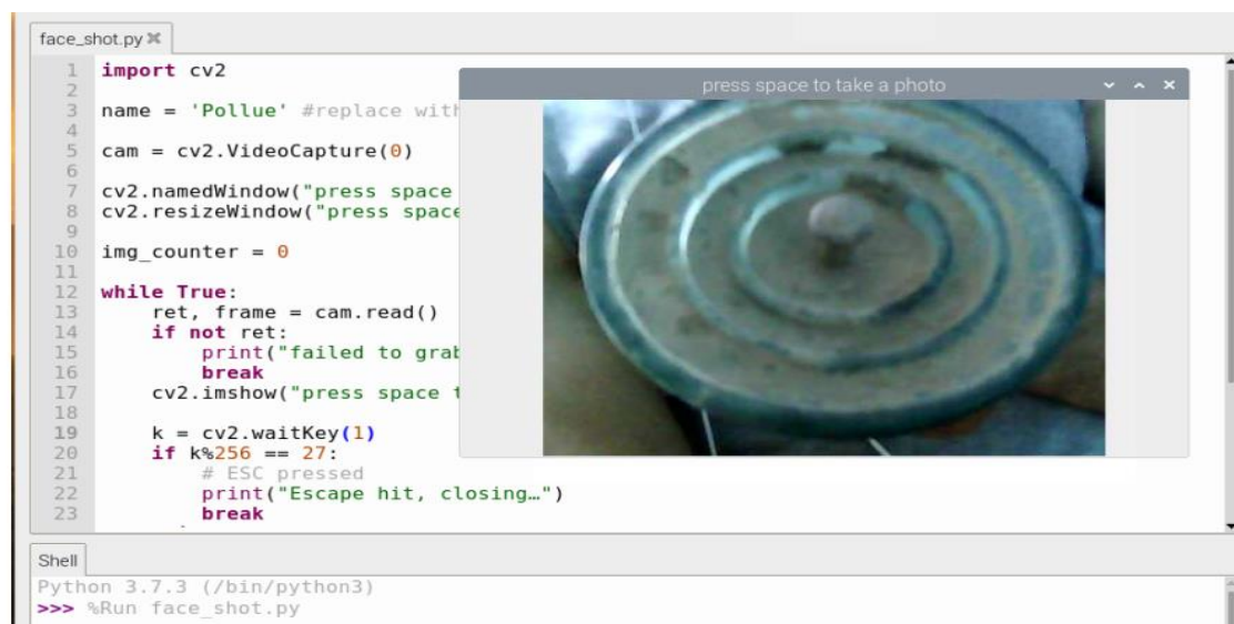
Figure IV.14. Exécution du code et l'enregistrement des photos pour les isoleurs
