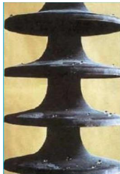
Figure I.12. Vieillissement d'un isolateur composite
