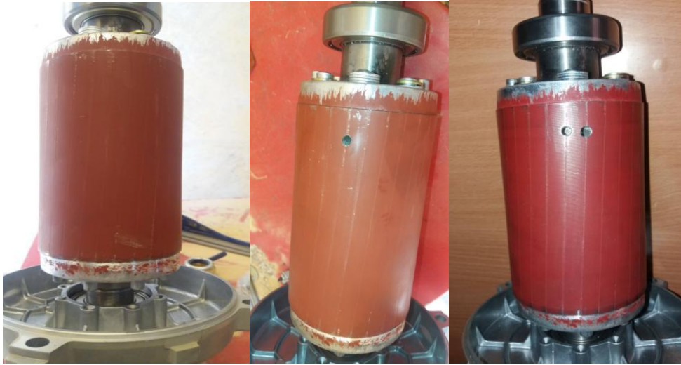
Figure (III.1) : Photographie des rotors de la MAS de 3 kW pour un état sain (à gauche), une barre cassée (au centre), deux barres cassées (à droite).
