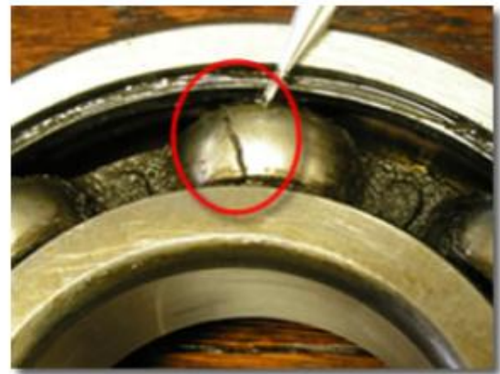
(b) défaut de cage à bille
