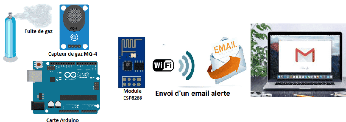
Figure (V-6) : Exemple d'intégration de détecteur dans les micro-systèmes : Système de détection des fuites de gaz intelligent contrôlé par Arduino.
